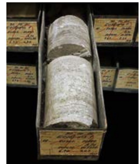
Ill. 72 Carotte de sondage du forage pour la recherche d'hydrocarbures réalisée en octobre 1981 à Éclépens. Cette carotte de calcaire a été prélevée à 2097m. de profondeur. Diamètre: 12 cm.
